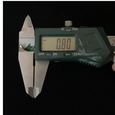
Figura 11: Control de espesor de las muestras de cerámica de 0.8 mm de espesor.
