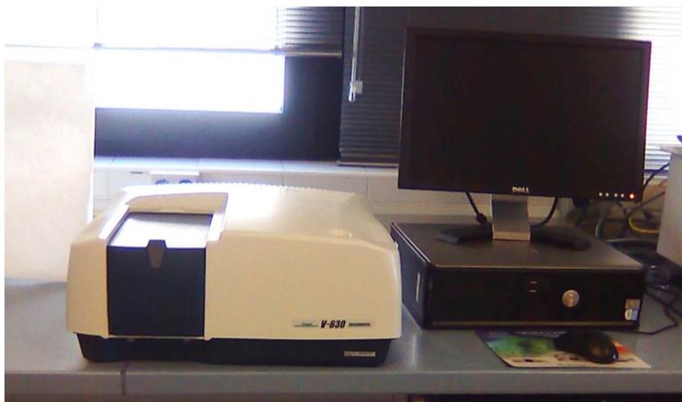
**Figura 4.4. Fotografía del espectrofotómetro Jasco V-630**
