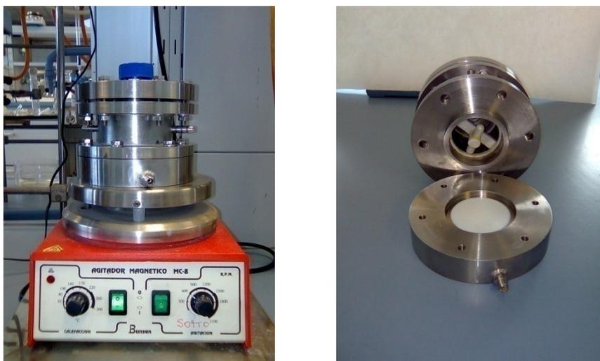
Figura 4.1. Fotografía de la celda empleada en los estudios de adsorción
