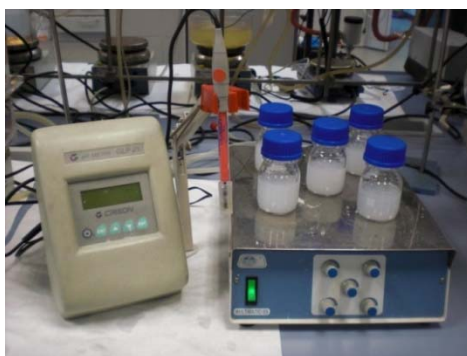
Figura 4.2. Instalación experimental utilizada para realizar los ensayos de equilibrio de adsorción de Hg(II) en disolución acuosa.
