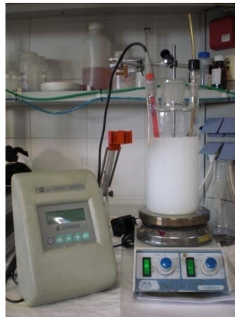
Figura 4.1. Instalación experimental utilizada para realizar los ensayos cinéticos de adsorción de Hg(II) en disolución acuosa.
