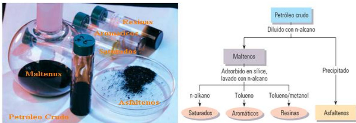
Figura 4. Fotografía de los productos de un análisis SARA y esquema de la realización del mismo [5].
