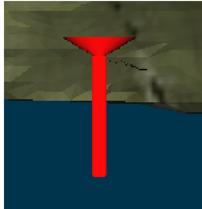
Figura 39: ejemplo de inclinómetro invalido por no estar anclado.
