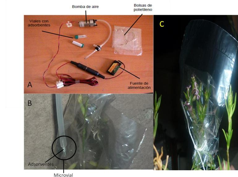
Figura 2. A, Material utilizado para la extracción de las esencias florales. B, microbial insertado en la bolsa. C, inflorescencia de *S. giraldii* embolsada.
