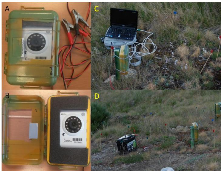
Figura 4. A y B, cámaras de video adaptadas, con una carcasa impermeable y conexión a batería. C y D, montaje de las cámaras grabando *S. ciliata* (C), con la ayuda de un ordenador portátil (encuadre), las estacas (fijación) y la batería (alimentación).
