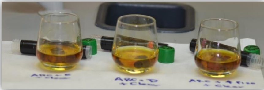
Figura 4.16: Muestras sumergidas en la solución fotorreveladora durante 8 horas y sometidas a la presencia de luz fluorescente.
