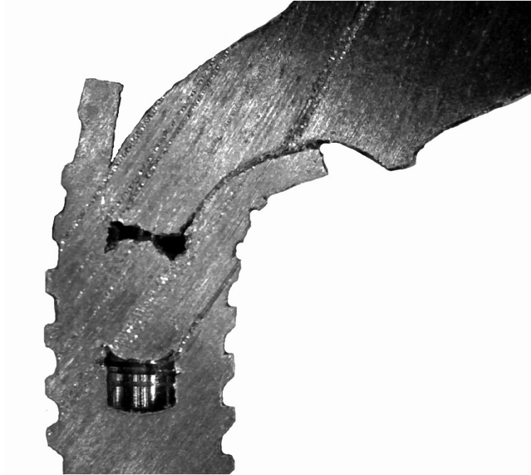
Figura 50 Corte longitudinal de un implante cono morse tras el ensayo de compresión
