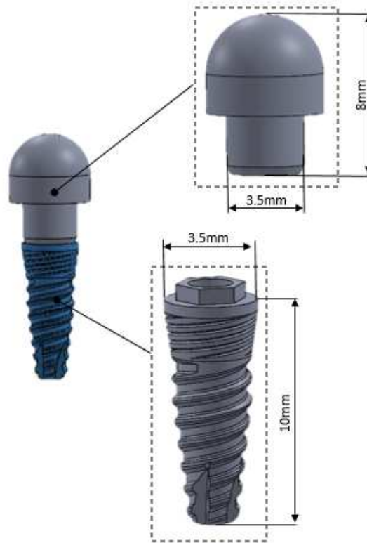
Figura 51 Principales cotas de la corona y el implante de conexión externa
