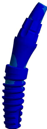
Figura 70 Modelo de elementos finitos en el que se aprecia la deformación sufrida durante el ensayo de compresión por el implante como morse, la corona y el tornillo de fijación
