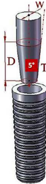
Figura 12 Esquema de un implante de cono morse. Fuente: (Balandra Ortiz 2013)
