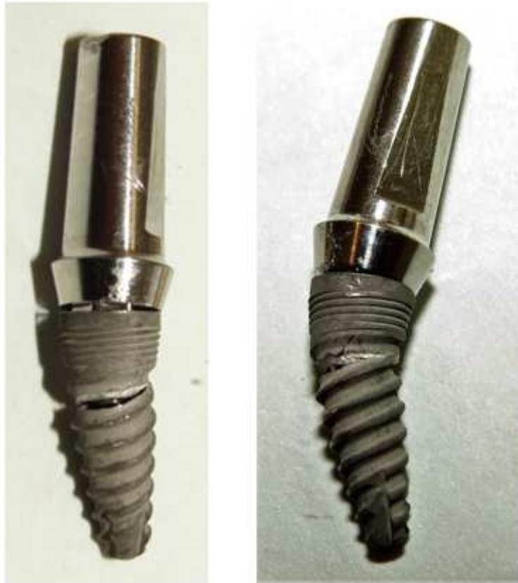
Figura 46 Imágenes de dos implantes HE tras el ensayo de compresión
