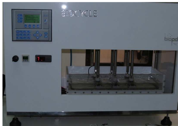
Figura 38 Imagen de los implantes sumergidos en agua a 37 \pm 2^\circ\text{C} y su ubicación en la máquina Biocycle
