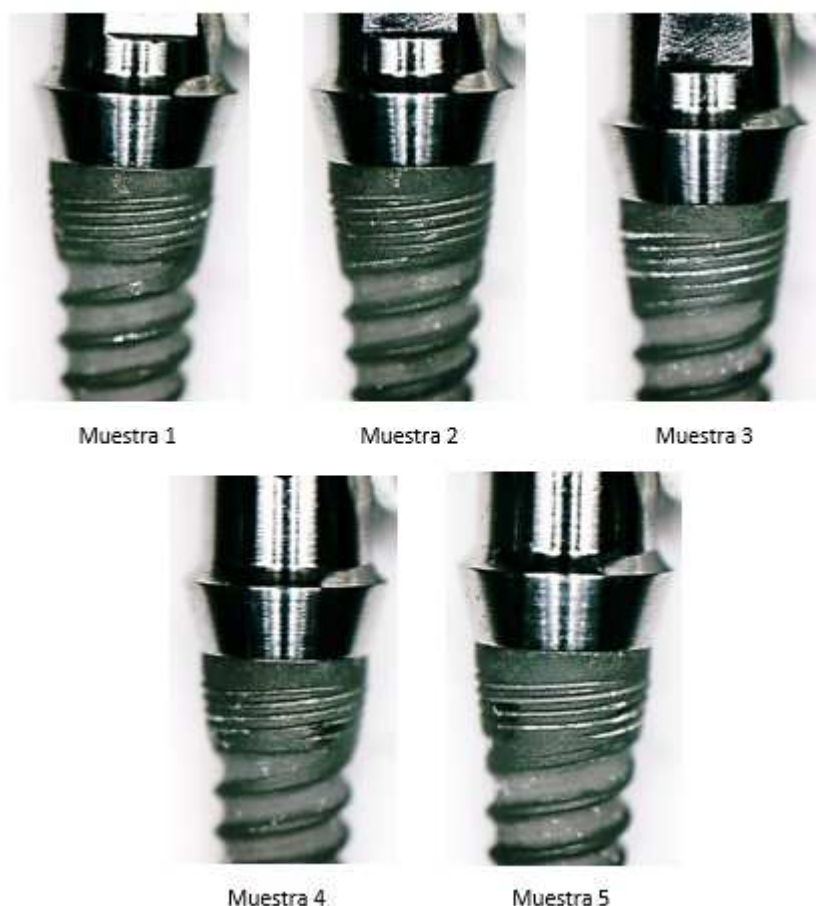
Figura 73 Imágenes de los implantes de conexión externa una vez ensayados a fatiga
