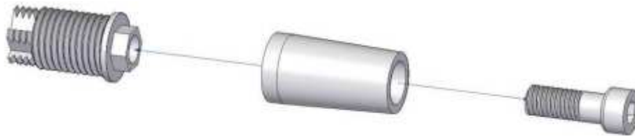
Figura 10 Sistema funcional de implante de conexión externa. Fuente: (Balandra Ortiz 2013)
