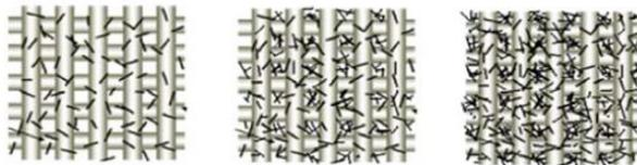
Figura 4.40. Representación esquemática de los mecanismos de filtración en materiales multiescalares fabricados mediante técnicas de infusión: (a) “*Cake filtration*” y (b) “*Deep bed filtration*”.
