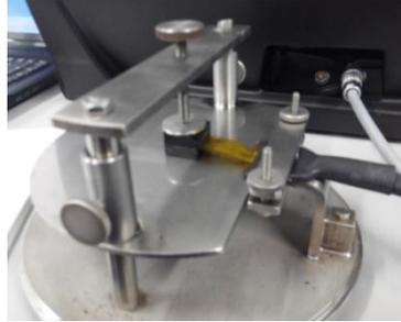
Figura 3.9. (a) Sensor Hot Disk embebido en kapton, (b) Soporte para las muestras.
