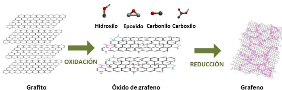
Figura 1.9. Síntesis de GNPs mediante oxidación del grafito y posterior reducción del óxido de grafeno [Bonaccorso, 2012].
