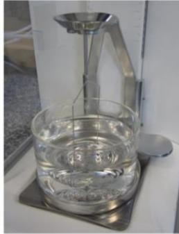
Figura 3.12. Kit de densidades para el cálculo del volumen de fibra, resina y huecos.
