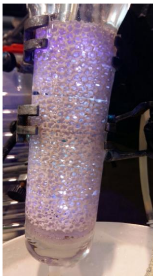
Figura 3.5. Fotografía del reactor de flujo ascendente funcionando como lecho fijo.
