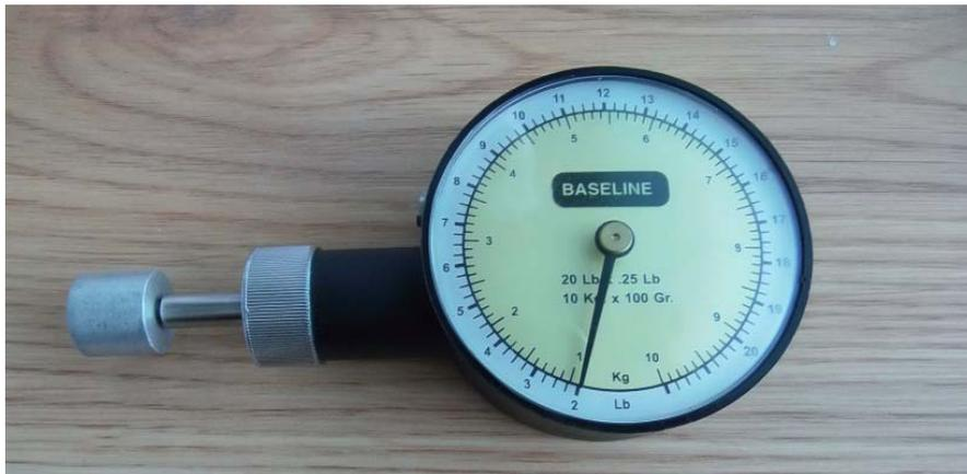
**Figura 1.** Algómetro (WAGNER Force Dial TM FDK 20/FDN 100 Series PushPullForceGage, Greenwich CT, USA).
