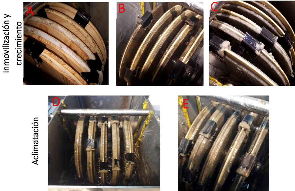
Figura 5.23. Evolución de la biomasa durante la puesta en marcha de los CBRs modificado: pretratamiento (A) 0 días; fase de inmovilización y crecimiento (B) 31 días y (C) 57 días; fase de aclimatación (D) 71 días y (E) 80 días
