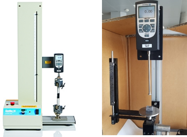
Figura 4.8. Banco estandarizado de pruebas mecánicas para ensayos de compresión.
