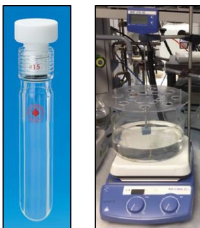
Figura 43. Reactor de borosilicato y sistema de calefacción utilizado en la reacción de deshidratación del sorbitol.
