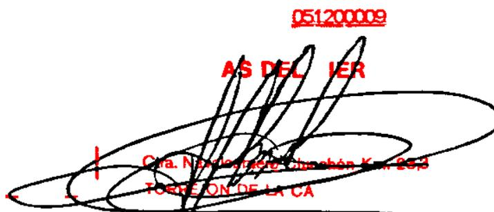
**Figura 3.17.-** Ejemplo del etiquetado manual realizado sobre el resultado de la segmentación. En negro los píxeles que realmente corresponden a la firma, en rojo píxeles correspondiente a ruido que no se ha filtrado correctamente.
