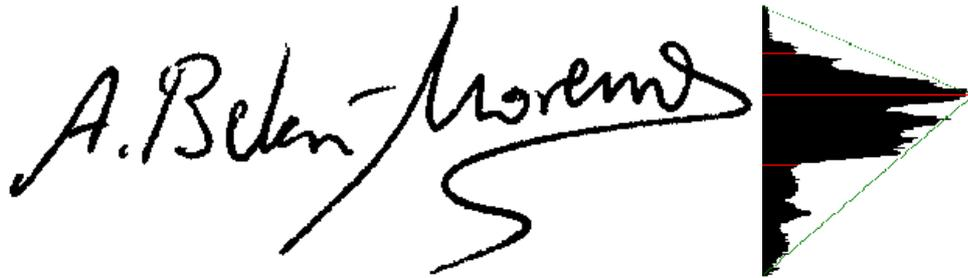
**Figura 4.21.-** Ejemplo de cálculo de la *BSL*, del *UL* y del *LL* de una firma, utilizando la proyección sobre el eje vertical de los píxeles activos de la imagen.
