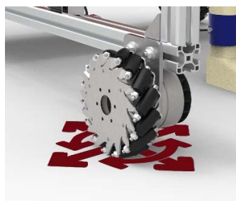
Fig. 2: Ejemplo de rueda omnidireccional en la plataforma D2W.
