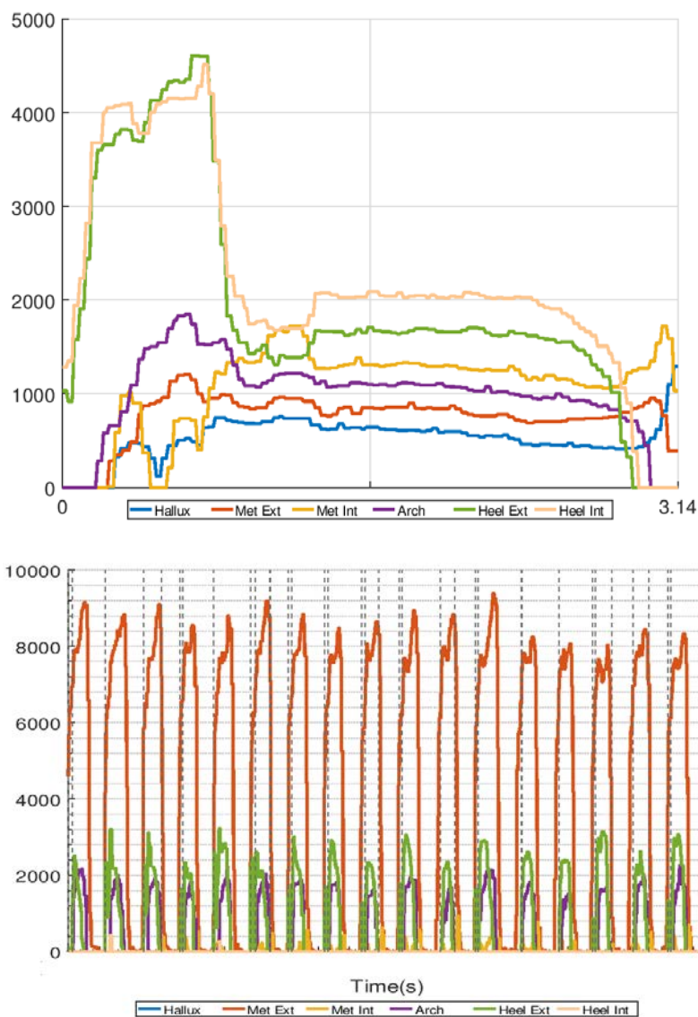
Fig. 2: Presión (mb) obtenida mediante los sensores de presión distribuidos en la planta del pie en uno de los pasos del lado menos afecto (superior), y total de presiones percibidas a lo largo de un recorrido de 10 metros caminando (inferior).
