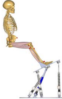
Fig. 1: Maniquí de AnyBody con el robot de rehabilitación de 4gdl
