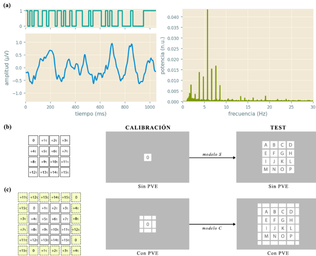
Fig. 1. (a) Plantilla principal x_0 de la m -secuencia empleada (izquierda arriba) en el dominio temporal (izquierda abajo) y frecuencial (derecha). (b-c) Esquema de retardos para cada uno de los comandos y metodología del estudio para (b) la matriz original y (c) la matriz con el principio de vecinos
