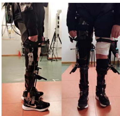
Fig. 1: Posicionamiento de los marcadores activos del sistema de fotogrametría CodaMotion. Fuente: Unidad de Biomecánica y Ayudas Técnicas, Hospital Nacional de Paraplégicos de Toledo (2021).
