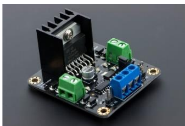
Figura 7. Controlador de motor SKU DRI0002, Mouser [57].
