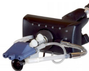
Figura 23. Fotografía del periférico QuadStick, en el que se puede observar como son los distintos sensores de sorbo y bocanada para actuar con los videojuegos.
