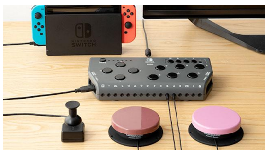
Figura 24. Fotografía del periférico HORI Flex con distintos elementos, como pulsadores conectados.
