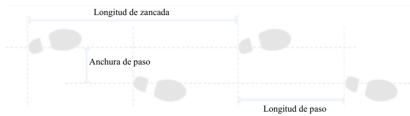
Figura 3. Longitud de paso, longitud de zancada y anchura de paso (Monge-Pereira et al., 2020).
