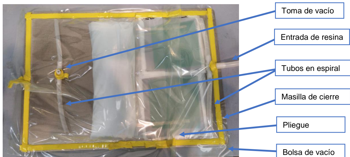
Figura 3-11: Montaje de VARIM.
