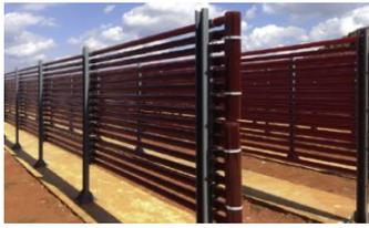
Figura 6: Cultivo de *H. pluvialis* en fotobiorreactores tubulares [13].
