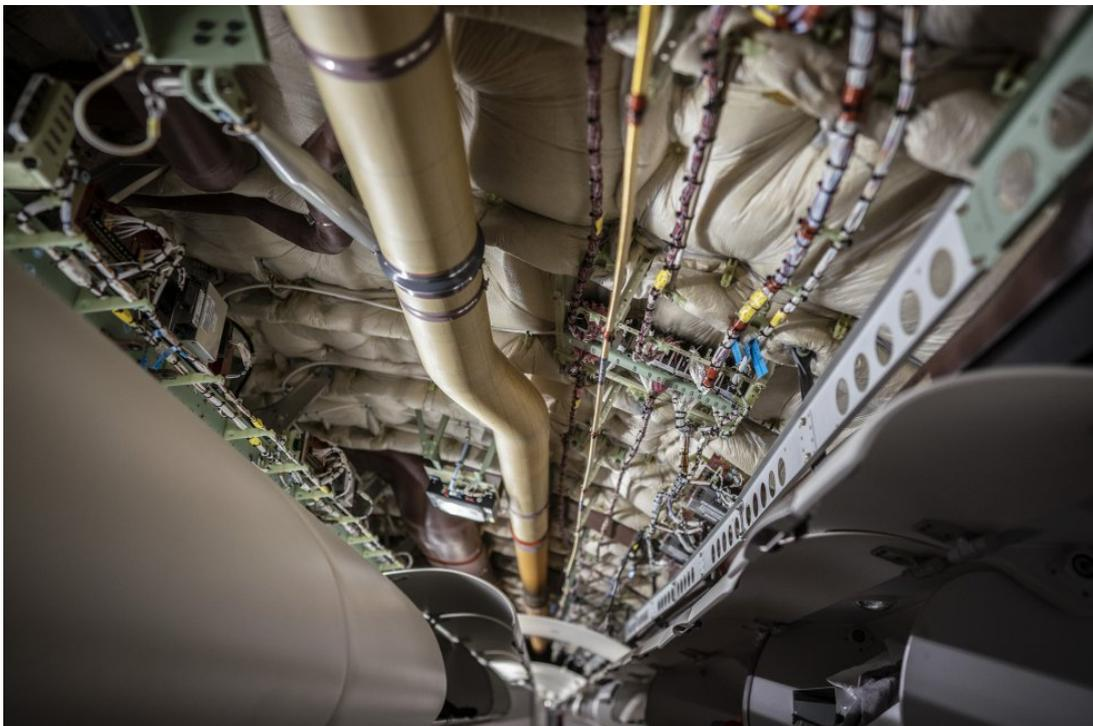
Figura 5.5: Cableado en el interior de un A330
