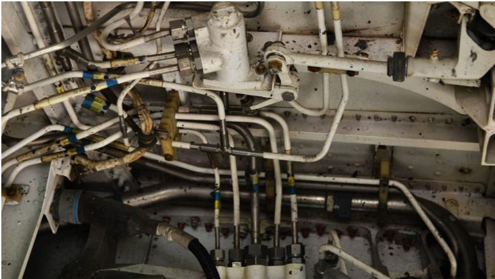
Figura 1.2: Tuberías hidráulicas de un avión.
