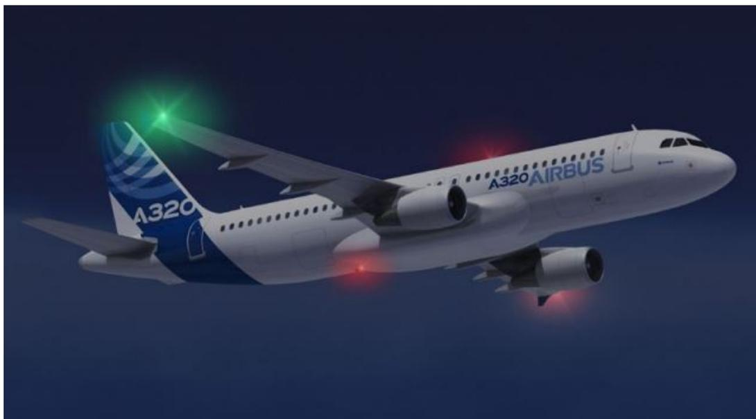
Figura 4.2: Luces de navegación. A320
