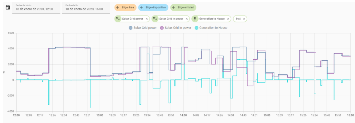
Figura 6-9. Evolución de la potencia total (azul oscuro), potencia vertida a la red (morado) y potencia consumida en la vivienda (azul claro) de las placas solares fotovoltaicas.
