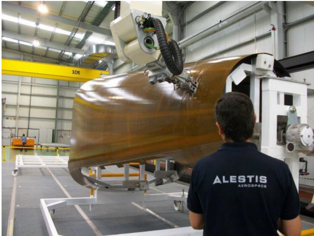
Figura 3: Procesado AFP para el cono de cola del A350 XWB [15]
