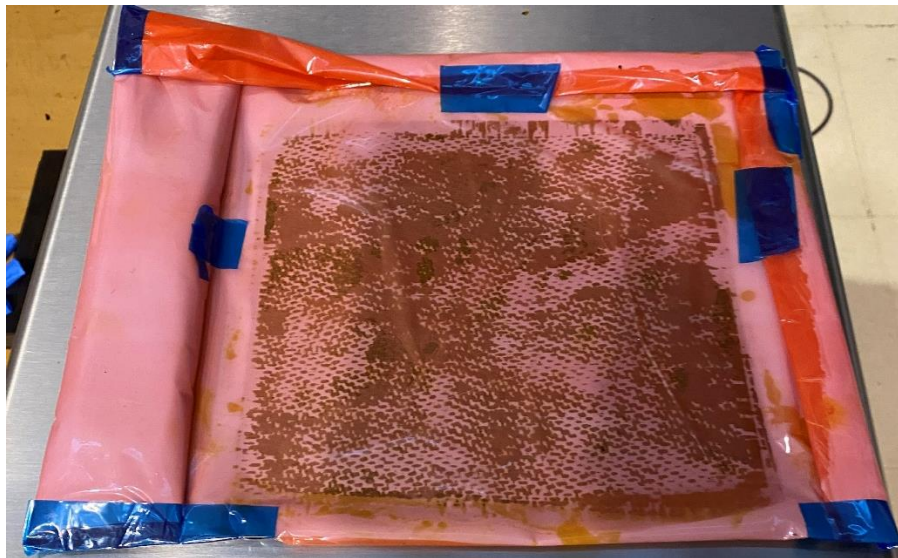
Figura 12: Laminado CFRP impregnado de resina, previo al curado.
