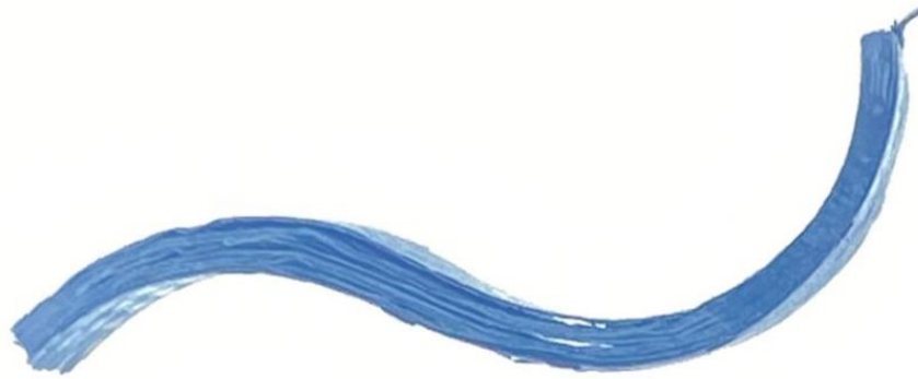
Figura 34: Probeta CFRP-8C-20% con molde de 360°
