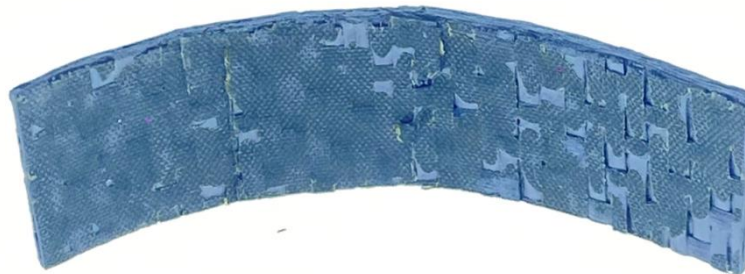
Figura 27: Probeta CFRP-4C-10% en molde de 135°
