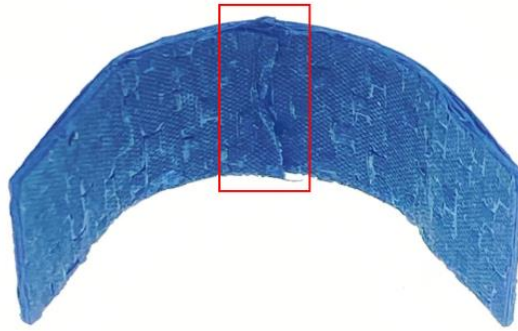
Figura 26: CFRP-4C-5% en molde de 180°. Fallo por flexión en zona central.
