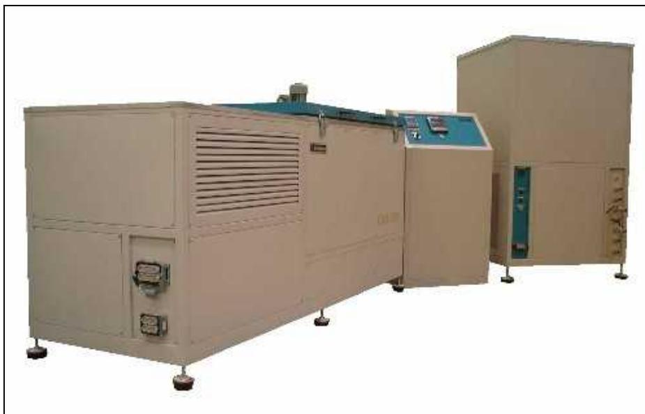
**Figura 4-7: Cámara de ensayos, pupitre de control y depósito termostático**
