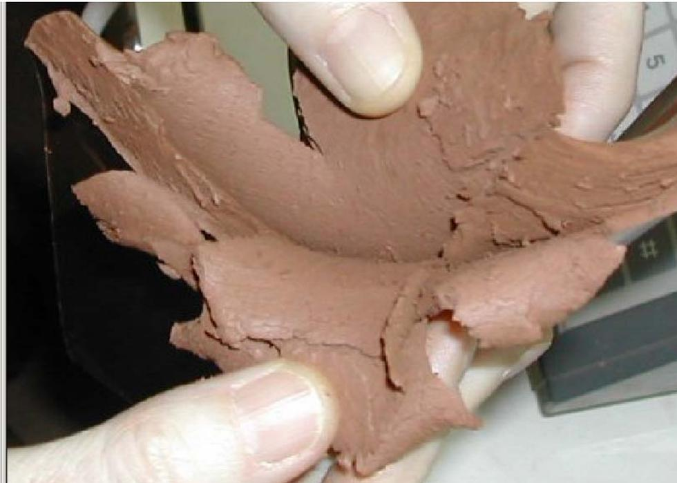
**Figura 5-5: Exfoliación en las tejas tras la extrusión**
