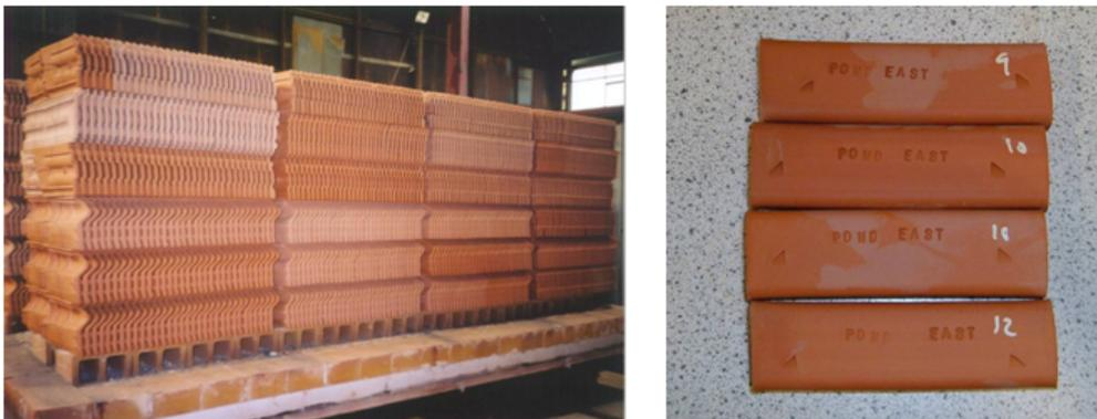
**Figura 2-66: Escorias en las tejas y muestras de laboratorio**
