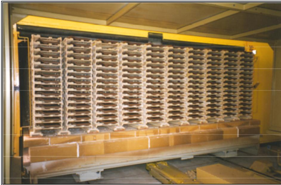
**Figura 2-51: Vagón de horno tipo túnel con H-cassettes como soporte de tejas**
