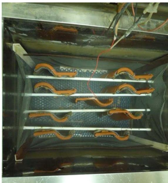
Figura 4-5: Cámara de ensayo cargada con tejas
