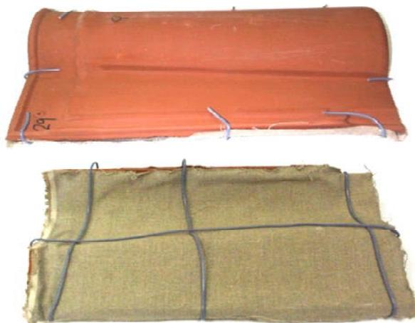
**Figura 4-4: Teja cubierta por un trozo de tela en su cara inferior**
