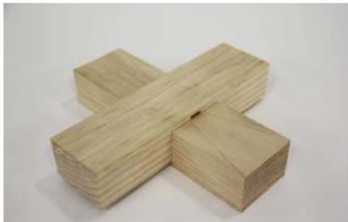
Inconvenientes de tolerancia en los ensambles realizados. Cormack y Sweet, 2016
