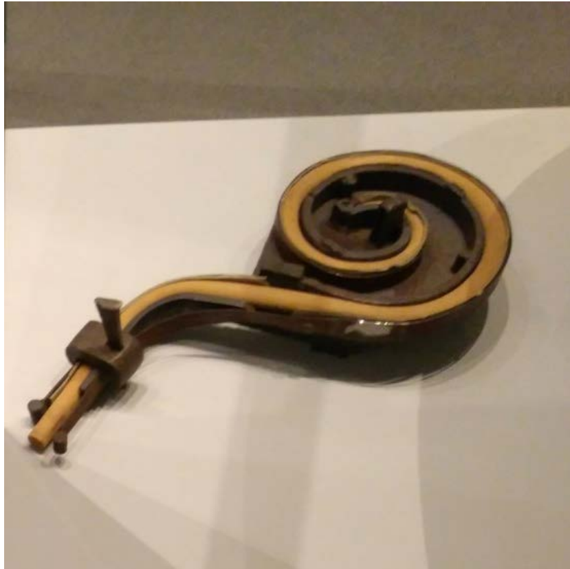
Molde de acero para doblado de madera de Thonet. Fuente: Armas-Crespo, V. Museo de diseño Munich.
