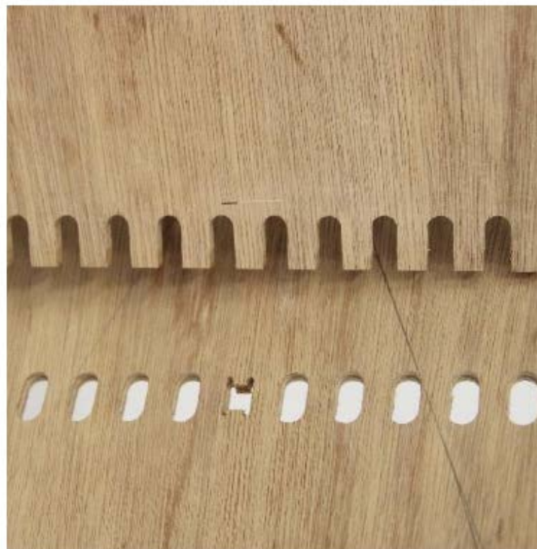
Ensamble Fingered mortise and tenon . Inconvenientes de lo virtual a lo físico. Cormack y Sweet, 2016
