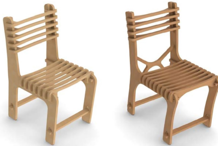
Skeleton chair . Izquierda: primer prototipo. Derecha: diseño final. En Šimek y Koreny, 2010.
