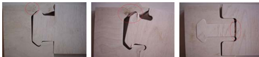
Encima: diagrama de deformación para los ensambles sometidos a esfuerzos en el plano angular. Debajo: resultado de rotura de ensambles Z (izquierda), MK (centro) y MD (derecha). En Langová et al., 2013.
