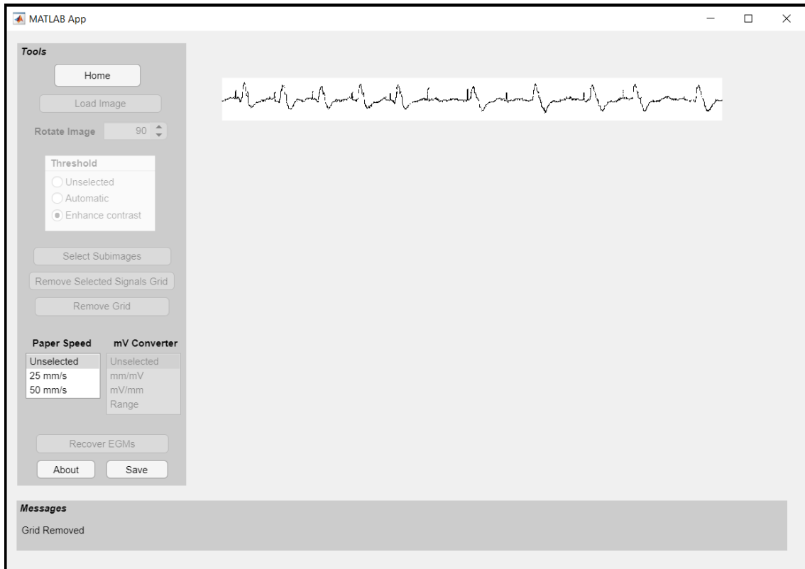
Figura 3.7: Interfaz de la aplicación tras haber eliminado la cuadrícula de una subimagen con mejora de contraste.
