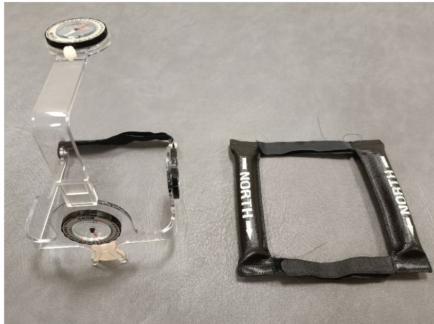
Fig. 37: Goniómetro utilizado para las mediciones del rango de movilidad cervical.
